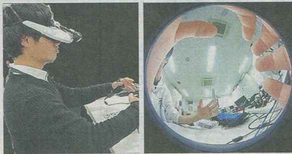
①手のひらに装着した魚眼カメラの画像 ②「ARろくろ試作システム」装着の様子
